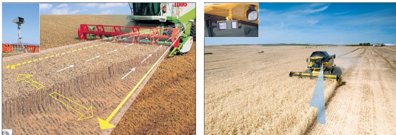
Obr. 4: Princíp práce laserovej navigácie obilného kombajnu, A – systém Claas LaserPilot, B – systém New Holland SmartSteer (claas.com, newholland.com).
