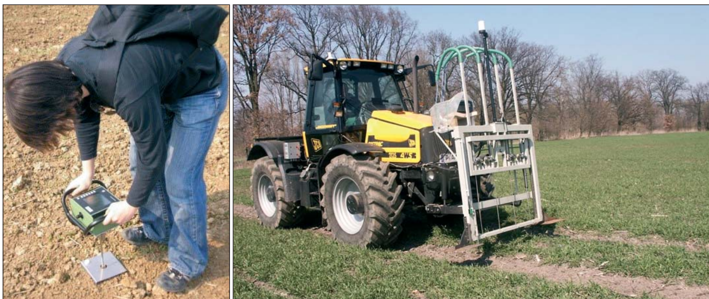
Obr. 2: Zariadenia na meranie utlačenia pôdy (A - ručný vertikálny penetrometer; B - automatický vertikálny penetrometer (Domsch et al., 2006).
