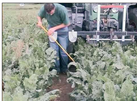
Obr. 5: Nastavenie ultrazvukových snímačov Reichhardt - PSR SONIC (reichhardt.com).
