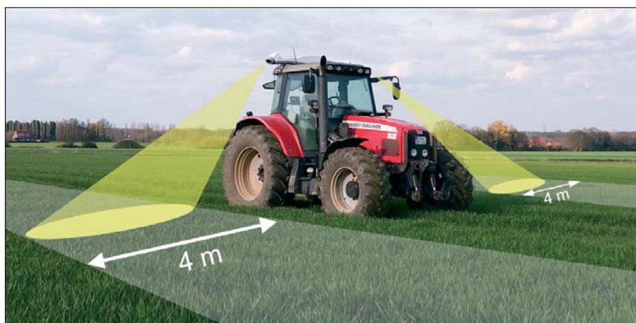
Obr. 5: Schéma snímania porastu YARA N senzorom (Leadingfarmers, 2019).
