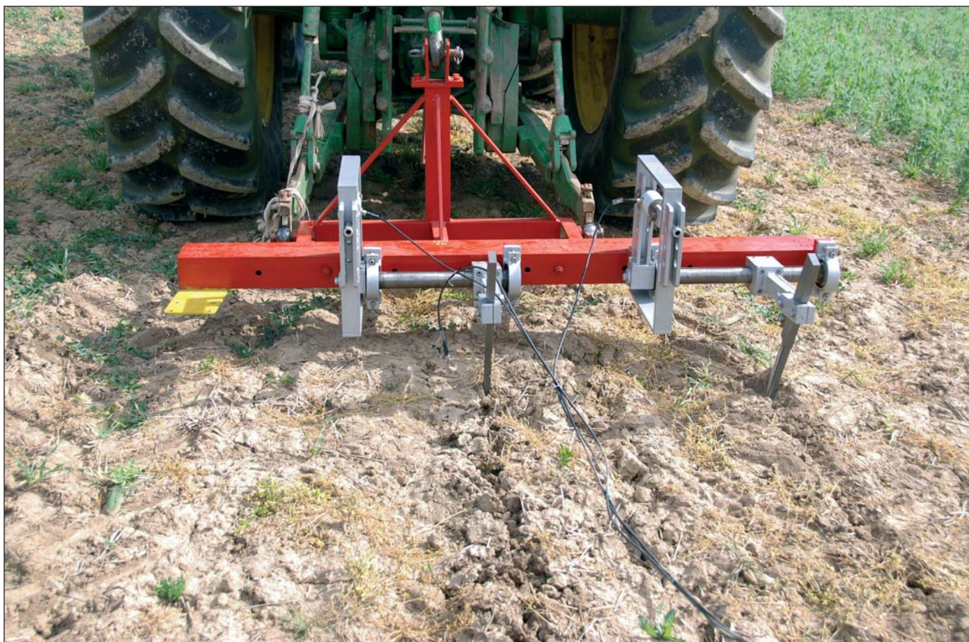
Obr. 8: Zisťovanie sily potrebnej na prekonanie odporu pôdy v rôznej utlačenej pôde.
