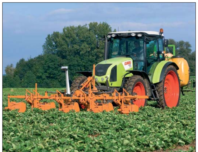
Obr. 3: Systém navigácie pomocou 3D kamery Agrom AYE-Drive, A: pri navádzaní stroja na riadok pokosenej trávy, B: pri navádzaní stroja počas plečkovania a lokálnej aplikácii chemických ochranných látok (claas.com).
