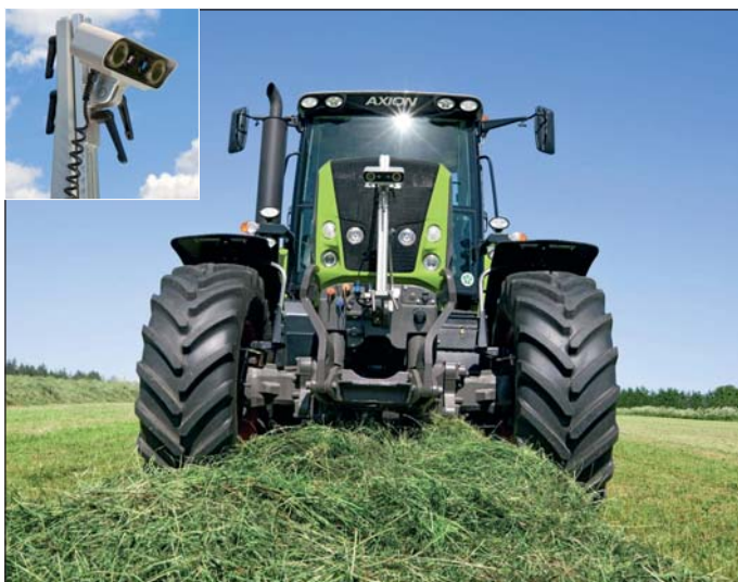
Obr. 3: Systém navigácie pomocou 3D kamery Agrom AYE-Drive, A: pri navádzaní stroja na riadok pokosenej trávy, B: pri navádzaní stroja počas plečkovania a lokálnej aplikácii chemických ochranných látok (claas.com).
