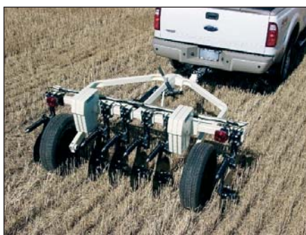
Obr. 7: Zariadenie na merania elektrického odporu pôdy (Veris Technologies) a schématický pohľad (Naderi-Boldaji et al., 2014).
