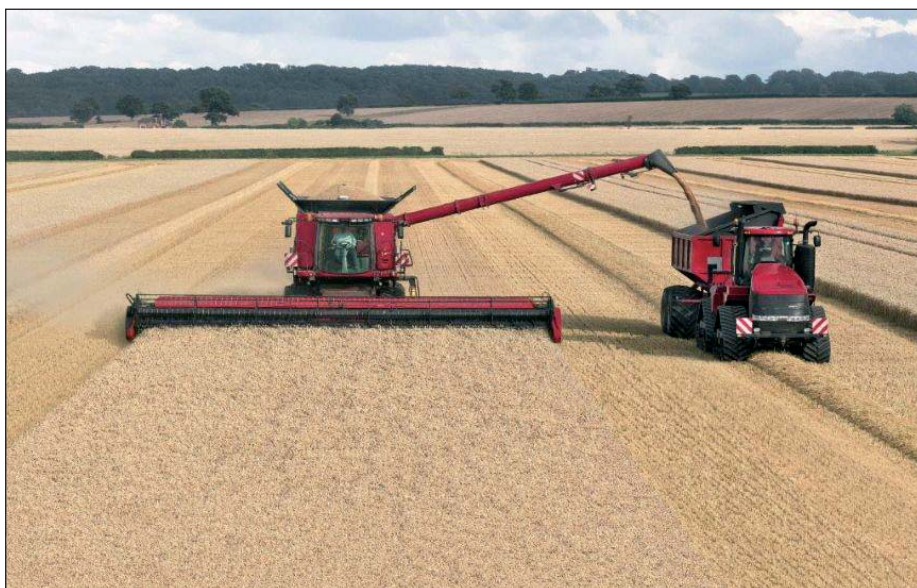
Obr. 4: Obilný kombajn so záberom 12,2 m, nasadený v systéme CTF (podľa: CTF Europe).
