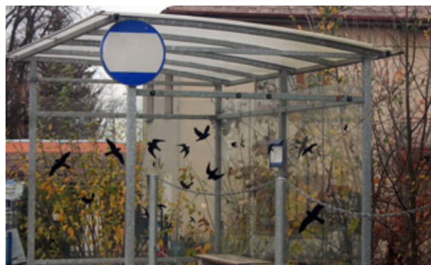
Obr. 10.61 Svislé pruhy nebo drátěná síť přímo ve stěně spolehlivě chrání ptáky před nárazy a zároveň představují přijatelná řešení z hlediska architektury. © Václav Hlaváč
